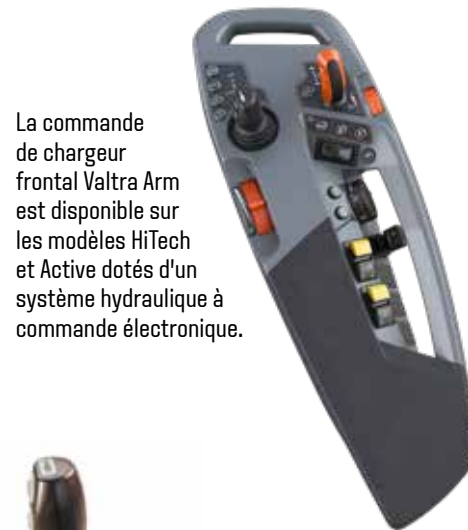
Commande du chargeur frontal à côté du siège (en option sur les modèles HiTech)
