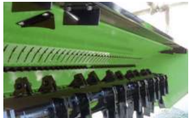
Zwei einstellbare Gegenschniden, mit jeweils 45 gezahnten Messern für unterschiedliche Häcksellängen
