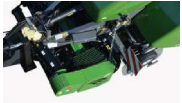
Starkes Zwischengetriebe, ausgelegt für Traktoren über 220 KW, mit integriertem Freilauf und Ein-Ausschaltung für den Häckslerantrieb
