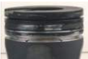
Kolbenring nach 300 Stunden mit Originalschmierstoff
