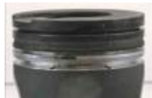
Kolbenring nach 300 Stunden mit Standard-Schmierstoff
