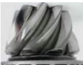
Kegelrad nach 300 Stunden mit Originalschmierstoff
