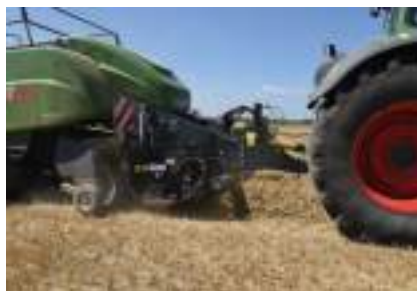
Müthing Vorbauhäcksler mit schnelllaufender Rotorwelle für gleichmäßige Schwadaufnahme, Zerkleinerung und Förderung des Häckselgutes
