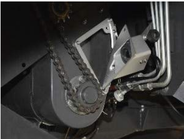
Überkehr-Kamera mit geöffneter Klappe
