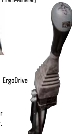
Frontlader-Steuerung neben dem Sitz (optional bei den HiTech-Modellen)
